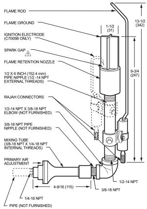
SPARK GAP BETWEEN IGNITION ELECTRODE AND GROUND MUST BE 1/8 TO 3/16 INCH (3.2 TO 4.8 mm). M3035B
