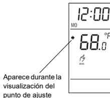
Para fijar el punto de ajuste, presionar uno de los botones ▼ ▲ hasta que aparezca la temperatura deseada.
